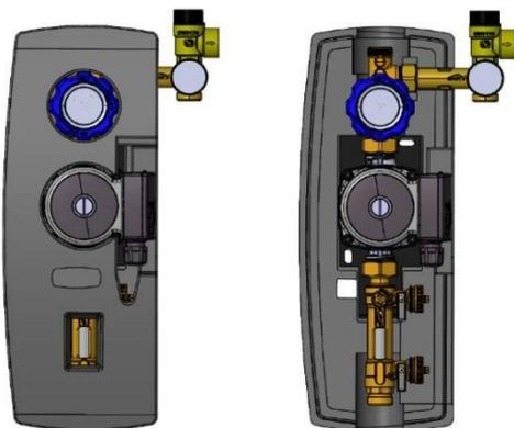
Die Pumpengruppe ist ein Gerät, das die Zirkulation der Solarflüssigkeit zwischen den Solarkollektoren und dem Speicher gewährleistet und regelt. Die Gruppe besteht aus einer Umwälzpumpe sowie Regel- und Messgeräten. Sie können sowohl für flache Sonnenkollektoren als auch für Vakuumkollektoren verwendet werden.
